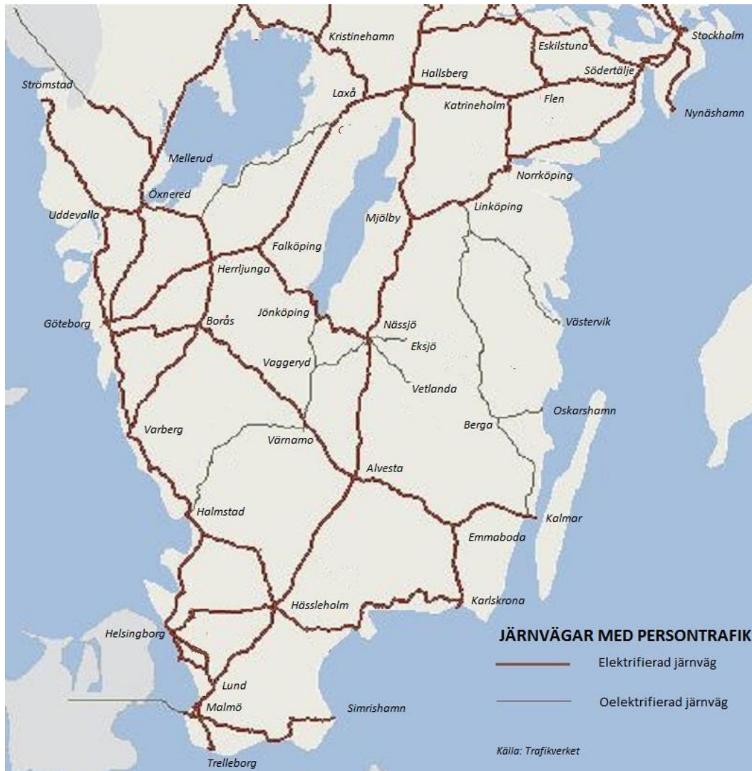
Figur 1. Bilden visar elektrifierade respektive oelektrifierade järnvägar med persontrafik i Södra Sverige. (Källa:Trafikverket)
